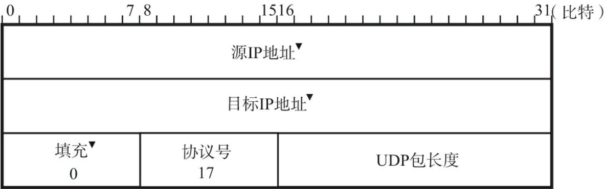
图6.25 校验和计算中使用的UDP伪首部
