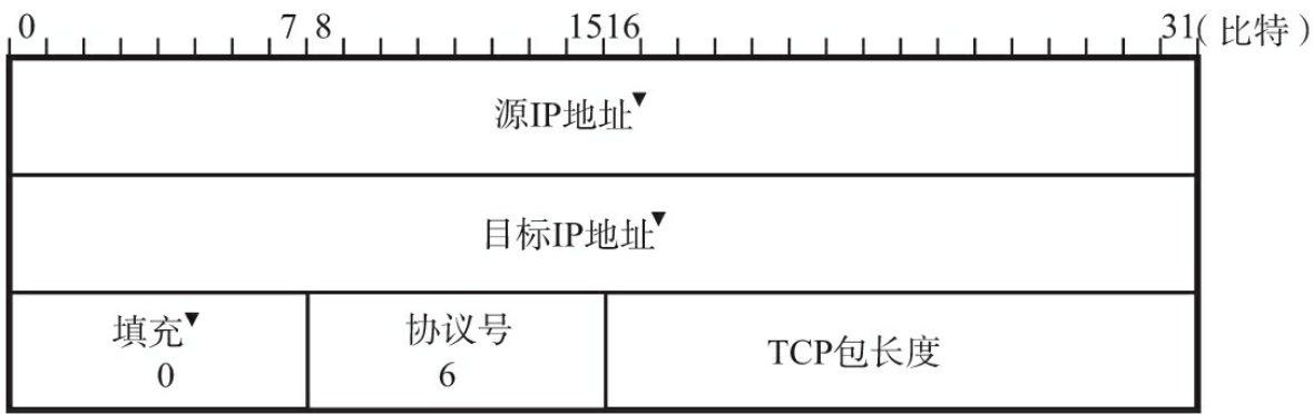
图6.28 用于校验和计算的TCP伪首部
